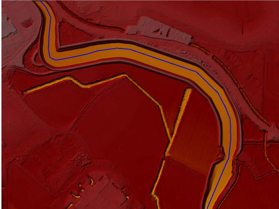
Figura 5.3 – particolare che riporta inserimento dell'argine e rimodellazione del corso d'acqua realizzato in comune di Milano, a nord di Peschiera Borromeo
