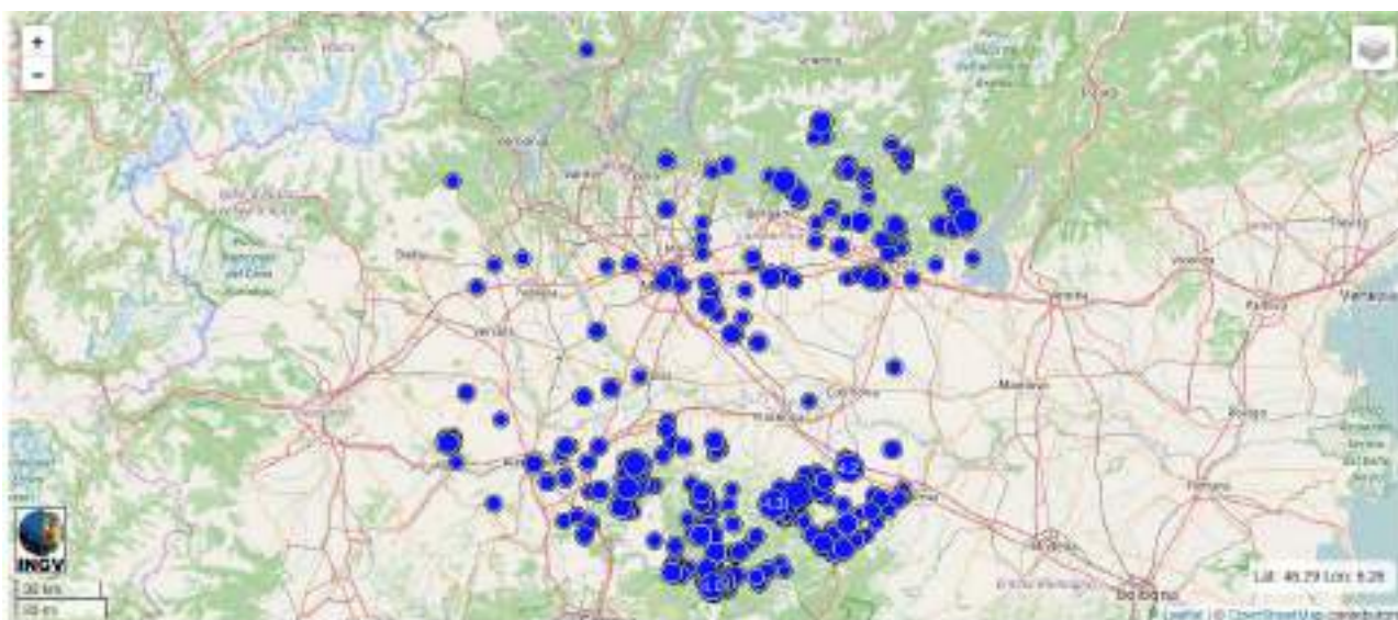
Figura 4 Distribuzione spaziale della sismicità degli ultimi 10 anni entro 100km dal sito dello stabilimento (elaborazione sulla base dei dati del Centro Nazionale Terremoti INGV, http://cnt.rm.ingv.it ).
